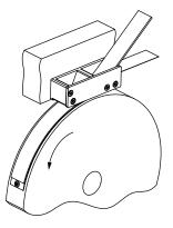
① Install the applicator for DS19 scale.
